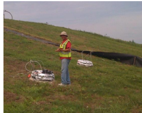
Figura 2-13: Cámaras de flujo en un relleno sanitario
