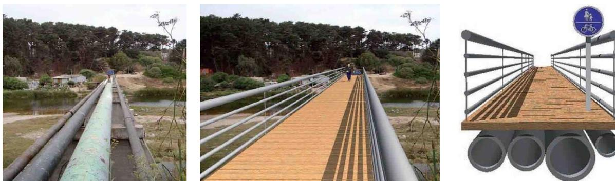
Figuras 181, 182 y 183. Propuesta técnica para la construcción de una pasarela peatonal y mirador en la laguna de Córdoba sobre las actuales tuberías de agua potable. Izquierda, vista actual de las tuberías. Centro, pasarela y mirador propuesto. Derecha, corte transversal de la estructura. Según el proyecto Agenda de Innovación en Destinos Turísticos “Red Verde de San Antonio - Litoral de los Poetas”.
