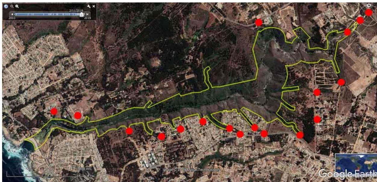
**Figura 115.** Posibles localizaciones de sitios de infiltración (puntos rojos) en la periferia del SNQC.
