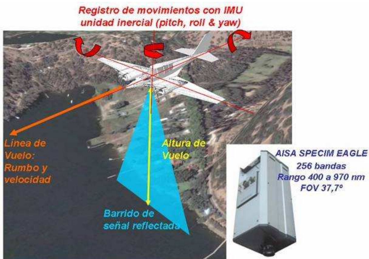
Figura 3.6. Diagrama de la obtención de reflectancia con el sensor hiperspectral AISA Eagle Specim. Se muestran los parámetros de programación de la adquisición de datos como la línea, velocidad y altura de vuelo, como también los parámetros de movimiento que registra la unidad de movimiento inercial (IMU) que permite efectuar la posterior rectificación espacial.
