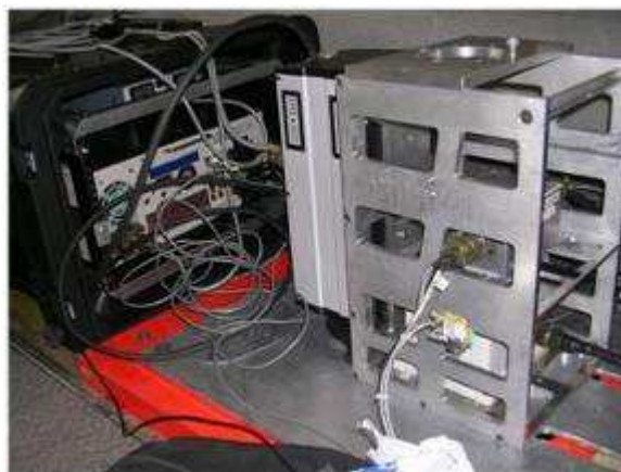
Figura 3.7. Sensor AISA-Eagle Specim montado en avión Cessna 401 bimotor.
