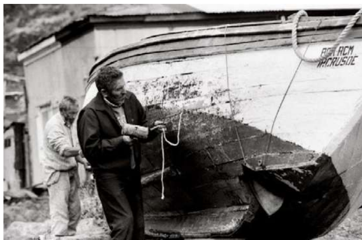
Figura 86. Embarcación artesanal de madera con tradicional diseño doble proa, símbolo de la cultura fernandeciana, utilizada para la pesca artesanal en Juan Fernández e Islas Desventuradas. Actualmente, son muy pocas las embarcaciones de este tipo que siguen operando, siendo reemplazadas por diseño proa espejo y de fibra de vidrio. Créditos imagen superior: Juana González Camacho. Créditos imagen inferior: Juana González Camacho.
